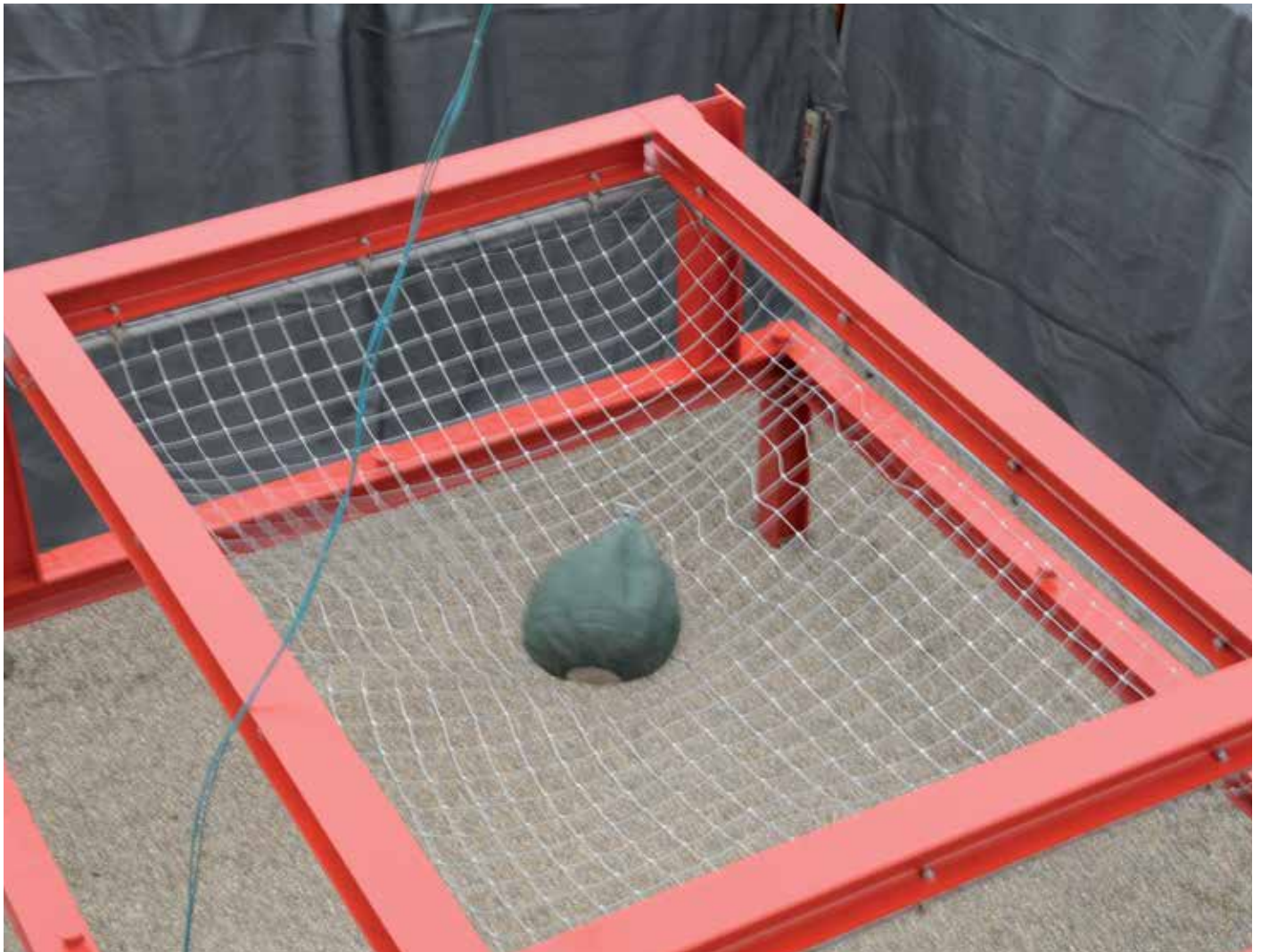
Prüfung Drahtseilnetz DRALO in einem Test-Rahmen
