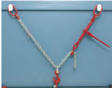
5 Typ V, Gk 8 Nutzlänge pro Zurrstang = 2,10 m*
